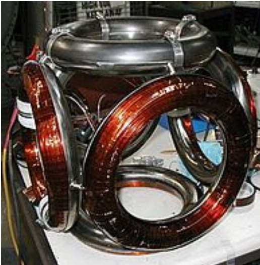
Fig. 2 Magneterna till en liten Bussard Polywell reaktor (WB6) monteras.
